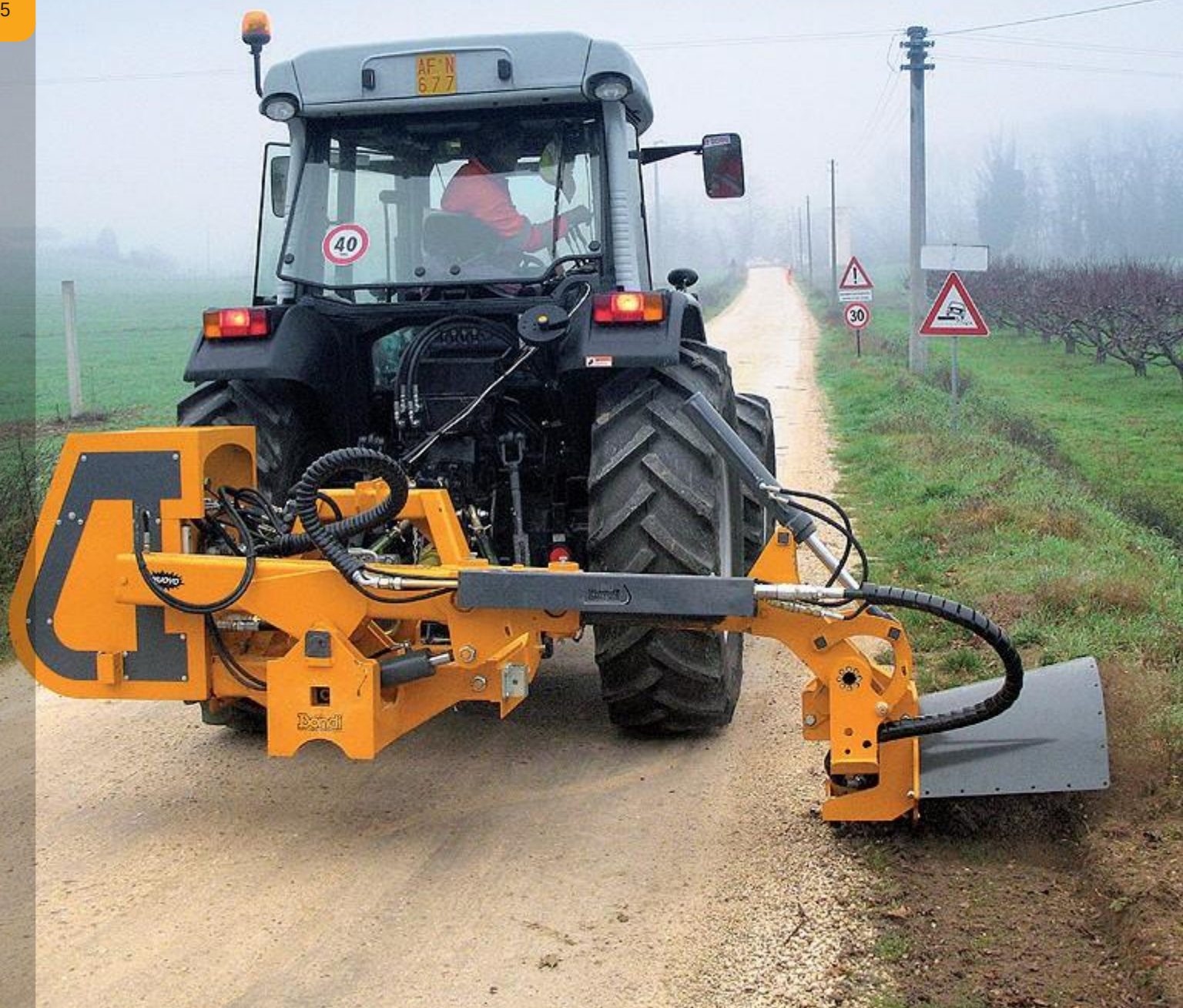
Крайпътна почистваща машина с хидравлично задвижване, оборудвана с режеща спирална глава, предназначена за почистване на пътни банкети и създаване на малки канали за улесняване на отичането на водата.
